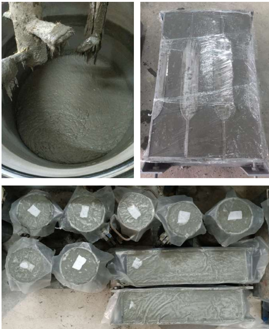
Hình 6. Công tác trộn và đúc mẫu kiểm tra chất lượng UHPC.
